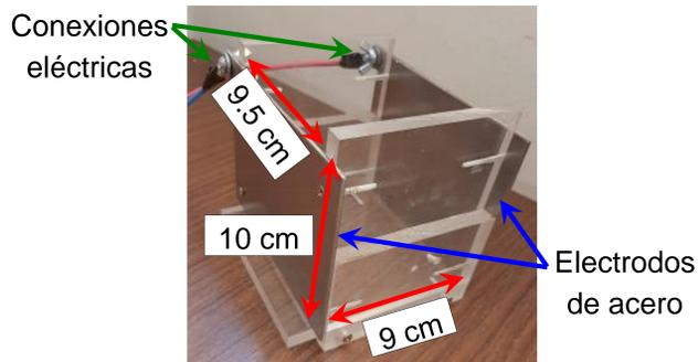
Luego de la cocción, la celda puede desmontarse para retirar la muestra cocida
